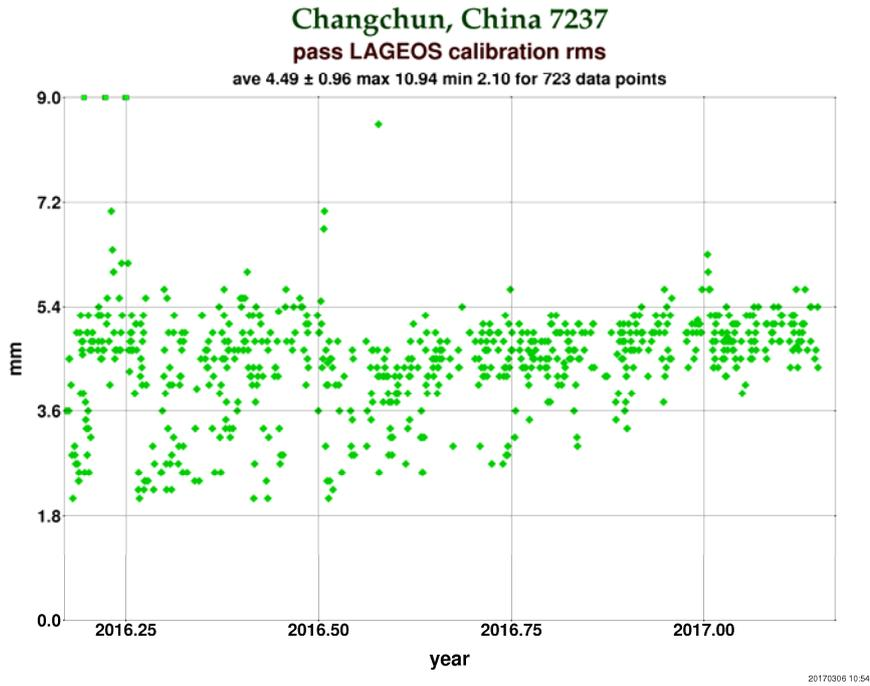
图 1.7.2 2016 年长春站 LAGEOS 卫星的校靶精度
