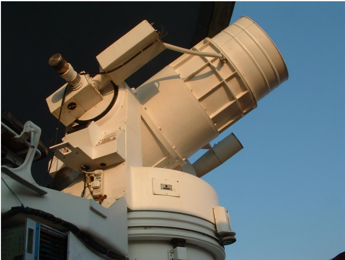
60 厘米高精度激光卫星测距仪
